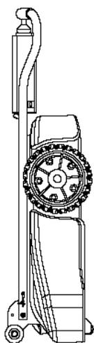
Attacher solidement les roues à traction en urethane au mur en position debout.
