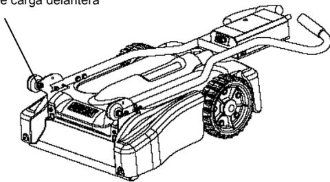
Ruedas de carga delanteras orientadas hacia arriba.
